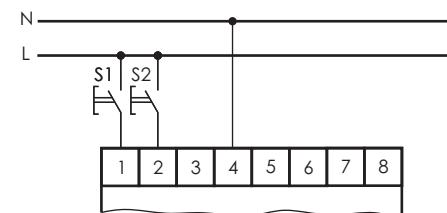
В данном режиме программа запустится только после поступления сигнала управления на клемму 1. При этом на клемме 2 + N(4) сигнал должен присутствовать постоянно. Это необходимо для включения реле. Подача напряжения только на клемму 2 и/или 3 включит реле времени, но не запустит выполнение программы.
