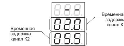
Чтобы перейти в меню настройки режима требуется на панели управления кратковременно нажать кнопку «OK». При этом на любой из входов (клеммы 1, 2, 3) должно быть подано напряжение.
