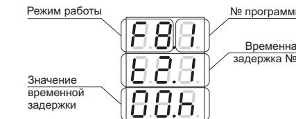
Нажатие кнопки «OK» инициирует выбор параметра «Значение временной задержки» для редактирования уставки времени t1.1. Об этом будет сигнализировано миганием параметра 1 раз в секунду.
