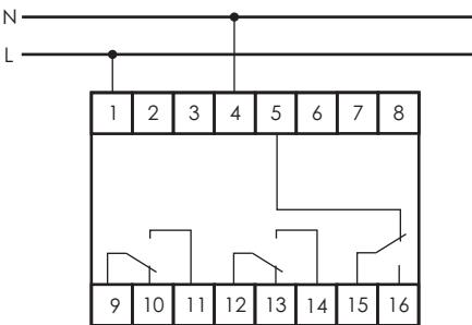
В данном режиме программа запустится когда на клемму 1 поступит напряжение. Подача напряжения на клеммы 2 и 3 включит реле времени, но не запустит выполнение программы.
