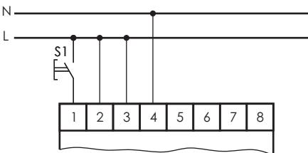
В данном режиме программа запустится только после поступления сигнала управления на клемму 1. При этом на клемме 2 и/или 3 + N(4) сигнал должен присутствовать постоянно. Это необходимо для включения реле. Подача напряжения только на клемму 2 и/или 3 включит реле времени, но не запустит выполнение программы.
