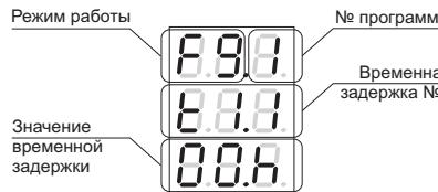
Нажатие кнопки «OK» инициирует выбор параметра «Значение временной задержки» для редактирования уставки времени t1.1. Об этом будет сигнализировано миганием параметра 1 раз в секунду.
