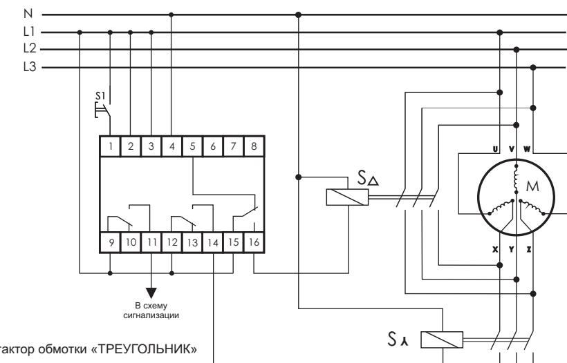
$S_\Delta$  - контактор обмотки «ТРЕУГОЛЬНИК»
