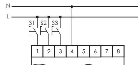
В данном режиме программа запустится при поступлении сигнала управления на клемму 1, 2 и 3. При этом поступление сигнала управления на клемму 1 + N(4) запустит выполнение программы первого канала (K1), поступление сигнала управления на клемму 2 + N(4) запустит выполнение программы второго канала (K2), поступление сигнала управления на клемму 3 + N(4) запустит выполнение программы третьего канала (K3).
