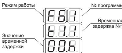
Нажатие кнопки «OK» инициирует выбор параметра «Значение временной задержки» для редактирования уставки времени t1.1. Об этом будет сигнализировано миганием параметра 1 раз в секунду.
