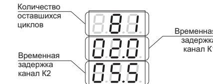
Если подано напряжение только на вход 1 то отображается только количество заданных циклов:
