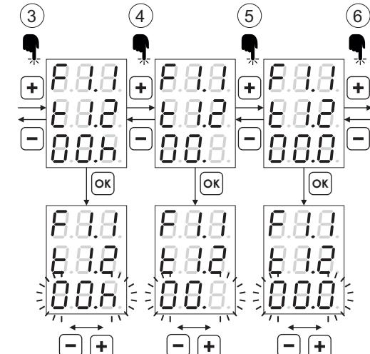
(6) Шестое (а также 7,8) нажатие кнопки «+» переводит пользователя к редактированию уставки временной задержки t2.1 канала K2.
