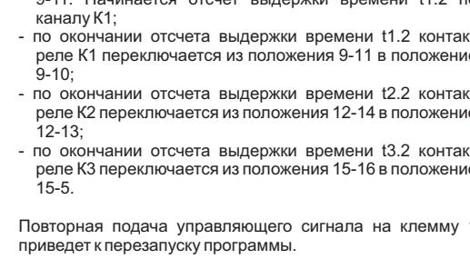
Повторная подача управляющего сигнала на клемму 1 приведет к перезапуску программы.
