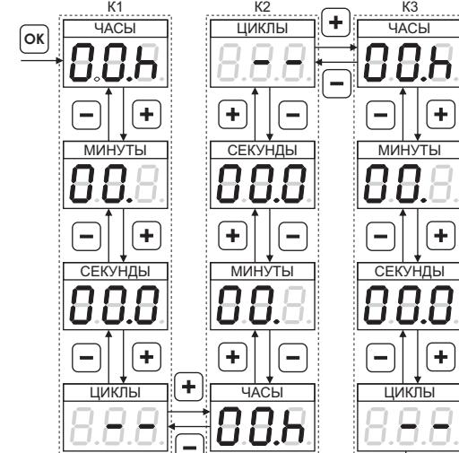
Все настройки реле сохраняются в энергонезависимой памяти и не пропадают при отключении питания. Пользователь имеет возможность задать и сохранить до 3-х программ в каждом режиме работы.
