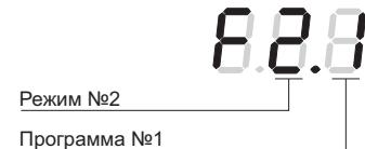
Кнопками «+» и «-» на панели управления выбрать нужный режим работы и номер программы. Нажать кнопку «OK» для выхода из меню выбора режима, либо дождаться автоматического выхода из меню.
