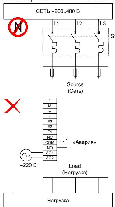
С использованием аварийного отключения и сигнализации:
