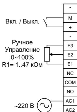
В этом режиме регулировка мощности осуществляется **внешним потенциометром**, а включение и выключение нагрузки – **внешним контактом** (выключатель, реле и т.п.).
