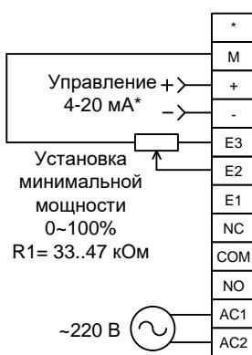
В этом режиме регулировка мощности осуществляется управляющим сигналом **4-20 mA\***, а нижний предел регулировки мощности задается внешним потенциометром.
