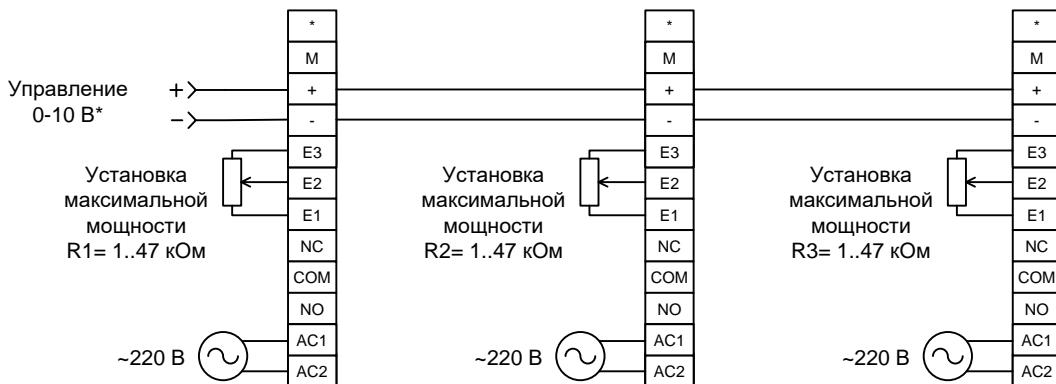
В этом режиме регулировка мощности осуществляется управляющим сигналом **0-10 В\***, а **верхний предел регулировки мощности задается внешними потенциометрами для каждого регулятора отдельно**.
