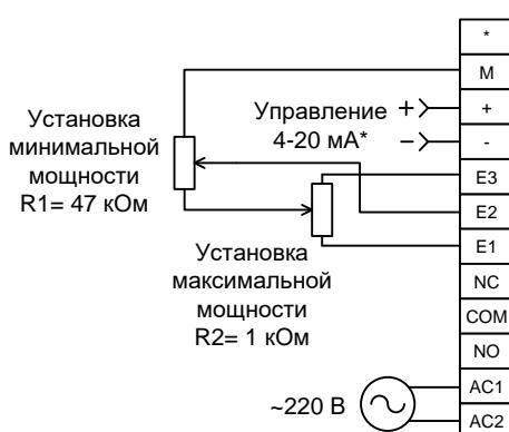
В этом режиме регулировка мощности осуществляется управляющим сигналом **4-20 mA\***, а верхний и нижний пределы регулировки мощности задается внешним потенциометром.
