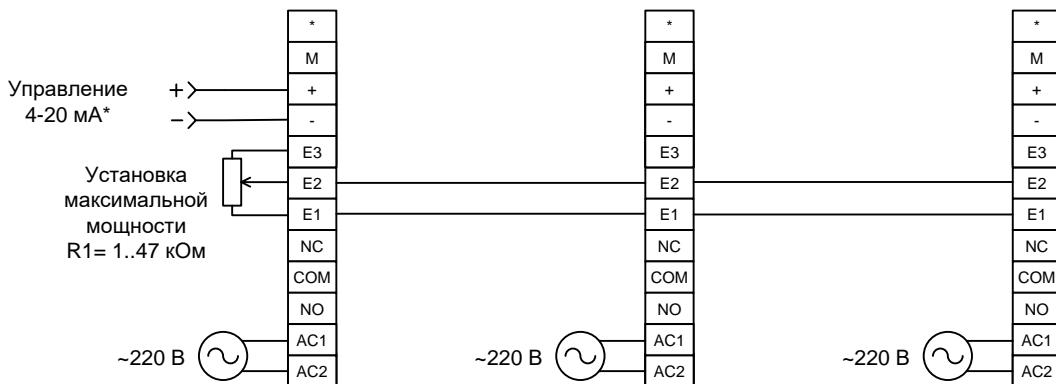
В этом режиме регулировка мощности осуществляется управляющим сигналом **4-20 mA\***, а **верхний предел регулировки мощности задается внешним потенциометром одновременно для всех регуляторов**.
