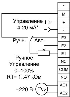
В этом режиме в «Аvt.» положении переключателя или реле регулировка мощности осуществляется управляющим сигналом **4-20 mA\*** до **максимального значения, заданного внешним потенциометром**, а в положении «Ручн.» - **полностью внешним потенциометром**, переключение между режимами управления осуществляется переключателем или контактами реле.
