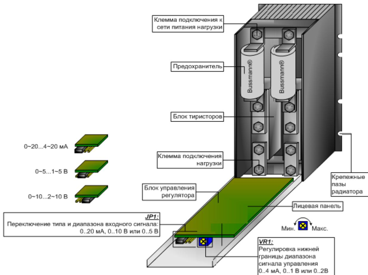
Крепление тиристорного регулятора осуществляется с помощью крепежных пазов радиатора.
