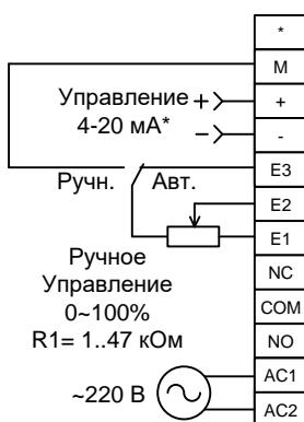
В этом режиме в «Аvt.» положении переключателя или реле регулировка мощности осуществляется управляющим сигналом **4-20 mA\*** до **максимального значения, заданного внешним потенциометром**, а в положении «Ручн.» - **полностью внешним потенциометром**, переключение между режимами управления осуществляется переключателем или контактами реле.
