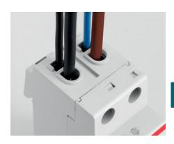
Доступны два клеммных разъема: передний для кабелей до 25 мм<sup>2</sup>, задний для кабелей до 10 мм<sup>2</sup> или для шин.
