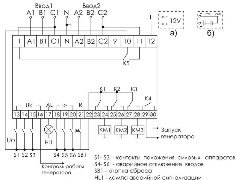
Рис.2 Схема включения AVR-02
