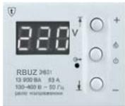
При включении устройство сразу начинает отображать значение напряжения сети. Если напряжение находится в допустимых пределах, включается нагрузка и начинает светиться зеленый светодиод. Если напряжение превышает верхний предел или ниже нижнего предела, тогда напряжение на нагрузку не подается.
