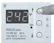
Для просмотра и изменения верхнего предела нажмите на кнопку «+», для просмотра и изменения нижнего предела — кнопку «-». В этом состоянии кнопками «+» и «-» можно изменить необходимый предел. Через 3 с после последнего нажатия кнопок, RBUZ вернется к индикации напряжения сети.
