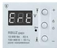
При обрыве или коротком замыкании датчика температуры прибор продолжает работать в обычном режиме, но каждые 4 секунды появляется надпись «Ert» на 0,5 с, означающая проблему с датчиком. В этом случае контроль за внутренним перегревом осуществляться не будет.
