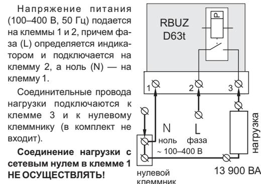
Схема 1. Упрощенная внутренняя схема и схема подключения
