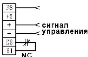
При замыкании E1-E2 отключает нагрузку
