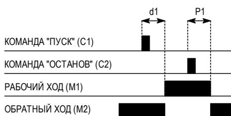
Рисунок 14 – Диаграмма работы приводом окна или фрамуги
