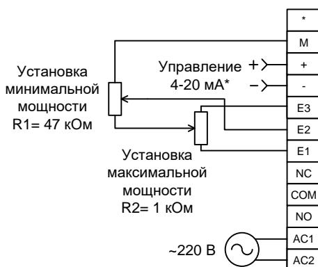
В этом режиме регулировка мощности осуществляется управляющим сигналом **4-20 mA\***, а верхний и нижний пределы регулировки мощности задается внешним потенциометром. Входной сигнал **4-20 mA\*** подается с соблюдением полярности на контакты + и -, его значение не должно превышать значений, заданных установками типа и диапазона входного сигнала
