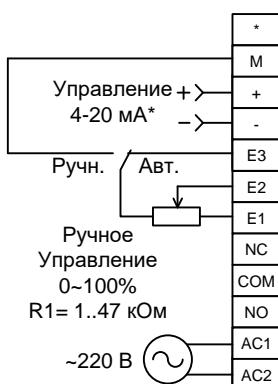
В этом режиме в «Авт.» положении переключателя или реле регулировка мощности осуществляется **управляющим сигналом 4-20 mA\* до максимального значения, заданного внешним потенциометром**, а в положении «Ручн.» - **полностью внешним потенциометром**, переключение между режимами управления осуществляется переключателем или контактами реле.
