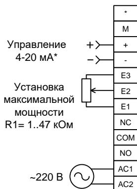
В этом режиме регулировка мощности осуществляется **управляющим сигналом 4-20 mA\***, а **верхний предел регулировки мощности задается внешним потенциометром**. Входной сигнал **4-20 mA\*** подается с соблюдением полярности на контакты «+» и «-», его значение не должно превышать значений, заданных установками типа и диапазона входного сигнала
