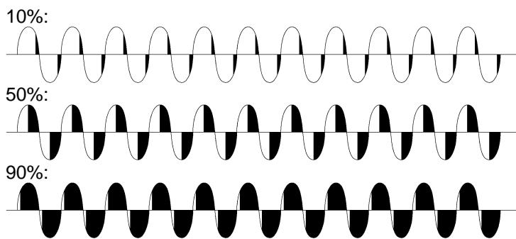
Тиристорные регуляторы, работающие в этом режиме, позволяют плавно изменять действующее (RMS) значение напряжения на нагрузке в диапазоне 0..100%.
