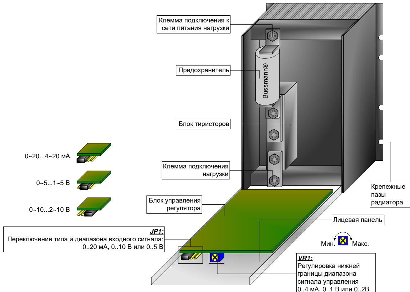
Крепление тиристорного регулятора осуществляется с помощью крепежных пазов радиатора.
