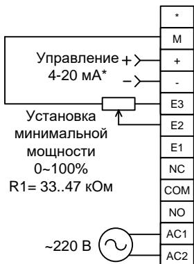
В этом режиме регулировка мощности осуществляется управляющим сигналом **4-20 mA\***, а нижний предел регулировки мощности задается внешним потенциометром.
