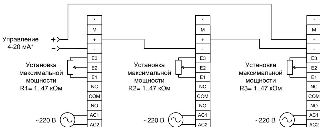
В этом режиме регулировка мощности осуществляется управляющим сигналом **4-20 mA\***, а **верхний предел регулировки мощности задается внешними потенциометрами для каждого регулятора отдельно**.
