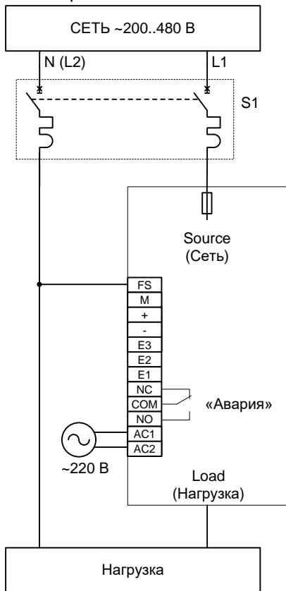
С использованием аварийного отключения и сигнализации:
