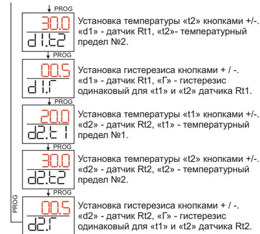
По истечении 8 секунд с последнего нажатия любой кнопки терморегулятор переходит в режим отображения температуры (рабочий режим).
