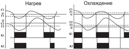
Реле K2 замкнет контакт только если замкнуты контакты K1. Работа по Rt1 и Rt2.
