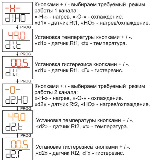
По истечении 8 секунд с последнего нажатия любой кнопки терморегулятор переходит в режим отображения температуры (рабочий режим).
