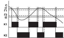
Контакты реле K1 замкнуты, если температура находится в пределах параметров от «t1» до «t2», контакты реле K2 замкнуты, если температура вышла за пределы параметров «t1» и «t2». Работа по датчику Rt1.
