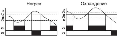
Работа по датчику Rt1. По температуре «t1» срабатывает реле K1, по температуре «t2» срабатывает реле K2. Пример: «t1» - основная температура, «t2» - аварийная
