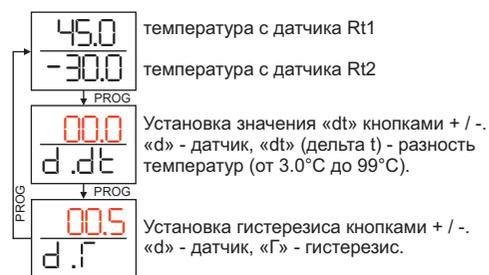
По истечении 8 секунд с последнего нажатия любой кнопки терморегулятор переходит в режим отображения температуры (рабочий режим).
