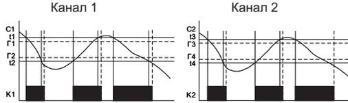
Изделие работает как два независимых терморегулятора в режиме «окно». Датчик Rt1 связан с параметрами «t1» и «t2» и контролирует выход реле K1. Датчик Rt2 связан с параметрами «t3» и «t4» и контролирует выход реле K2.
