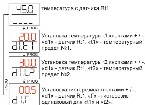
По истечении 8 секунд с последнего нажатия любой кнопки терморегулятор переходит в режим отображения температуры (рабочий режим).
