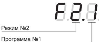
Кнопками «+» и «-» на панели управления выбрать нужный режим работы и номер программы. Нажать кнопку «OK» для выхода из меню выбора режима, либо дождаться автоматического выхода из меню.
